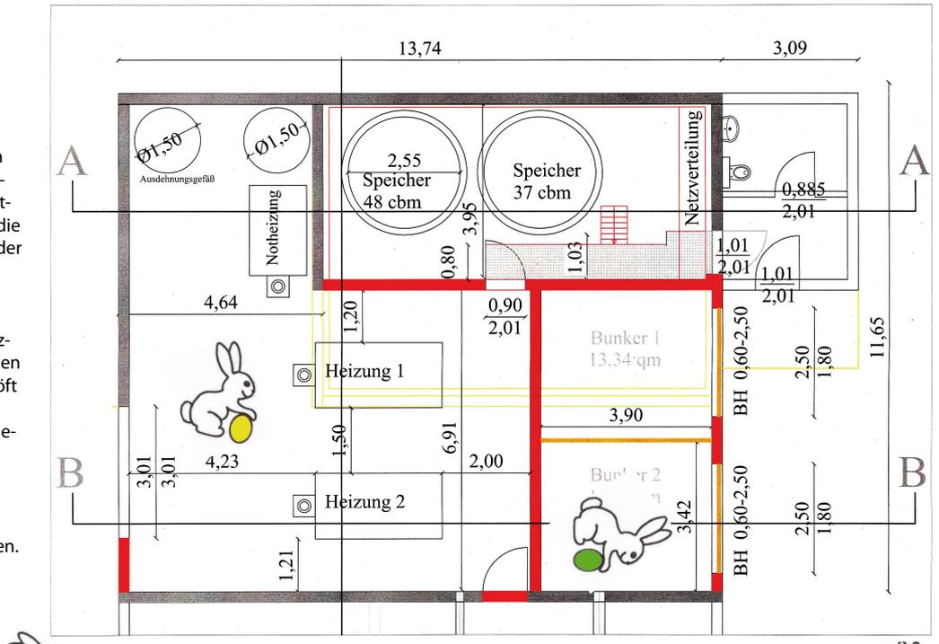
Das Heizhaus mit Wärmespeicher, Brennofen, Notheizung und Hackschnitzelbunkern
